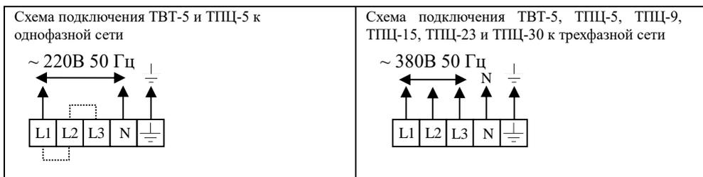
Подключить сетевой кабель согласно маркировке рядом с клеммной колодкой (клеммными зажимами).
